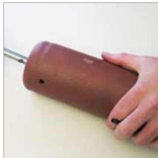
Rys. 03: Potem wprowadzić trzpień w obciążnik i przymocować drugim kołkiem rozprężnym.
