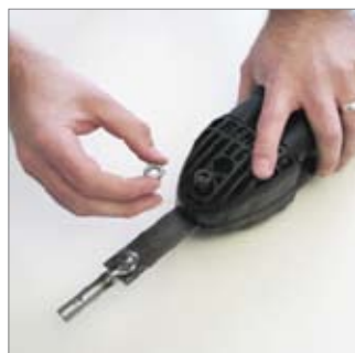
Rys. 02: Drugą sondę również umieścić w wyłobieniu i skręcić sondę za pomocą śrub i nakrętek.
