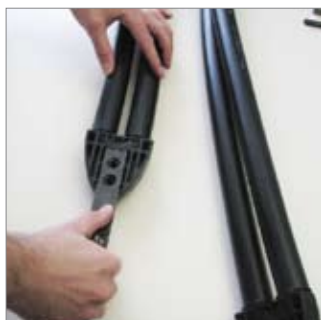
Rys. 01: Płaskownik umieścić w wyłobieniu.
