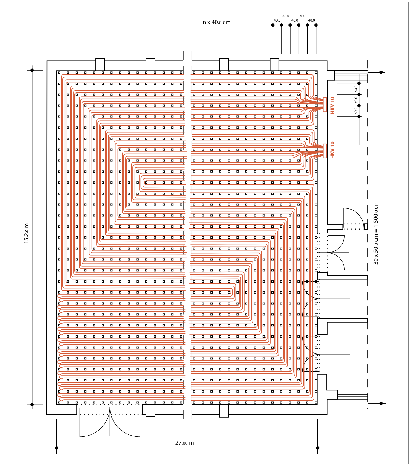
Fig. 16-33 Representación esquemática de una calefacción para pavimento elástico con colector estándar
