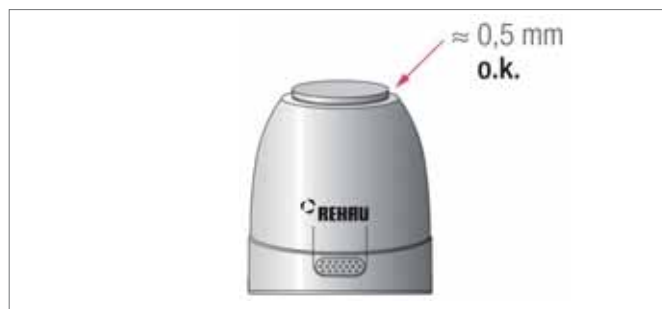
Fig. 10-51 Adaptación de las válvulas
