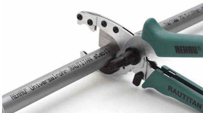
图9-1 使用管剪16/20切断 RAUTITAN stabil 管道
