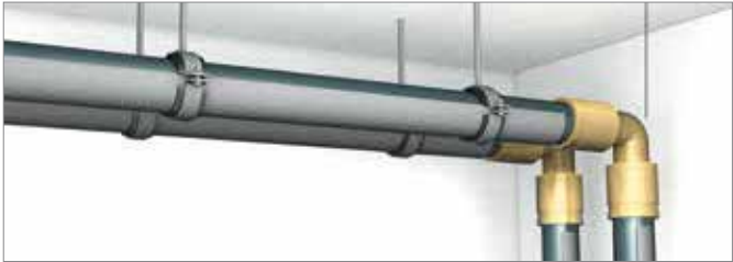
图14-3 最大管道支架的间距
