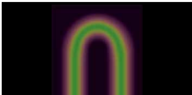
图26-30 通过热膜定位含热媒管道的位置
