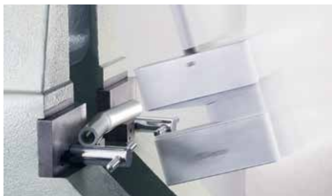
图4-6 缺口冲击强度测试装置中的通用管道 RAUTITAN flex
