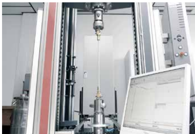
图4-7 拉伸试验程序
