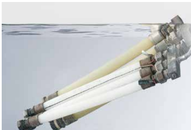
图4-8 进行长期试验中的管道（承受压力并被浸于水池中）
