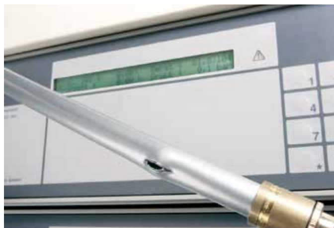
图4-5 通用管 RAUTITAN flex 的爆破
