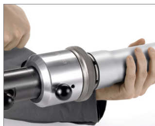
图 19 3. 将管道用 RAUTOOL G1 的扩张单元扩张两次，两次之间扩张单元需被旋转30°。基本上将扩张工具插到头，但是不允许歪曲。套环不允许处于扩张区域中。
