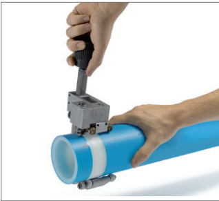
图 42 4. 在使用剥皮机器时，可以不用在管道上做标记。在这里管道只允许被剥皮一次！
