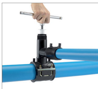
图 61 9. 在压力测试以后，借助于 NW12 内六角扳手将冲孔器旋入主管。
