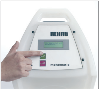
图 48 10. 按下焊接机器的开始按钮并且按照如下指南进行校验。比较在显示屏中的焊接参数和电熔焊接头上的数值。
