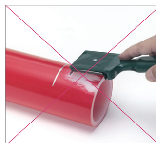
图 124 不要用手刮刀对管道进行削皮，这仅仅是作为后处理使用。需使用管道削皮刀（请看价格表）。
