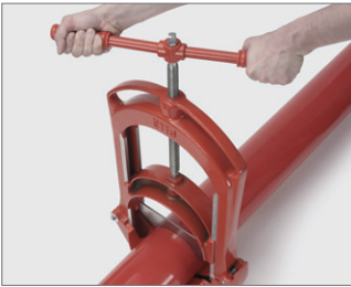
图 25 1. 用“斩首机”将管截出想要的长度……
