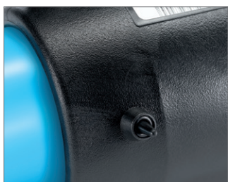
图 78 对于焊入的电熔焊套筒，在每个管道末端都有一个指示乳头是凸出来的。
