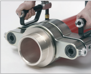
图 33 8. 将压缩工具 RAUTOOL G1 125-160 完全置于连接处。工具不允许歪斜。工具必须完全并呈直角被放置。
