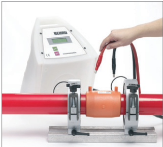
图 104 在焊接结束之后，将会发出声学信号。当屏幕上显示出“OK”。然后可以将插头移除。
