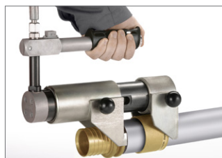
图 23 7. 将工具置于连接处。工具不允许歪斜。工具必须完全并且以呈直角的形式被放置。
