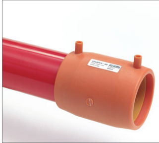
图 97 将 FUSAPEX 电熔焊套筒完全套入第一个管道的末端。
