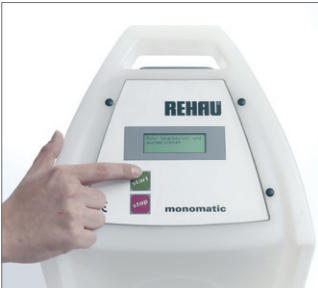
图 103 再按一次开始按钮来触发焊接过程。
