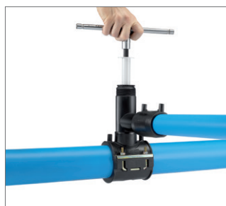
图 62 10. 在管道被旋破之后，将冲孔器按逆时针方向旋出至止挡。
