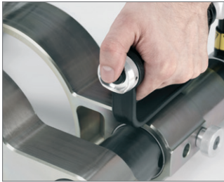
图 34 9. 通过操作在主汽缸上的压力开关，将套环推至接头凸缘处。如有必要，可将插销的位置在移动轭上进行调节。连接马上可以受压受温。
