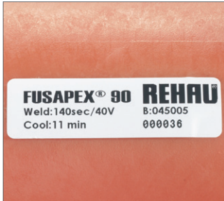
图 105 在接头所给出的冷却时间“cool...min”内，连接处不允许受压受力。
