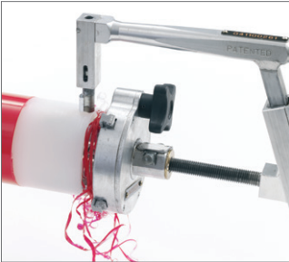
图 93 对管道削皮两次。
