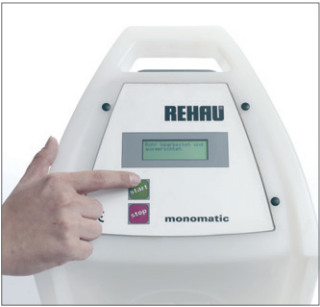
图 50 12.再按一次开始按钮来触发焊接过程。
