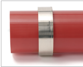
图 27 2. 将套环推至管上。套环内部的夹紧端必须要指向管的末端。
