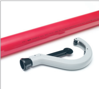
图 89 截出需要的长度。截面必须要平整、垂直于管轴并且无毛刺飞边。
