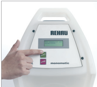
图 101 按下焊接机器的开始按钮并且按如下指南进行校验。比较在显示屏中的焊接参数和 FUSAPEX 电熔焊接头上的数值。
