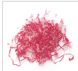
图 112 削皮的时候应该形成一个长且均匀（0.1 至 0.2mm 厚）的切屑；旋转式削皮刀和 / 或刀交替使用。
