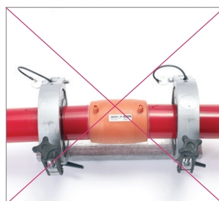
图 123 连接必须被校直，并且不允许处于压力之下。紧急情况下，松开管道再次重新固定。
