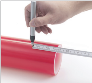
图 91 根据下列表格标记出刮削深度。使用具有对比色的笔。
