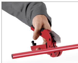
图 11 1. 用管道剪将管道无毛刺飞边并且呈直角状剪出想要的长度。
