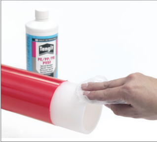
图 95 刮除区域应该无尘无油脂。用足够的 Tangit 清洁剂清洁，并且让清洁剂完全蒸发。
