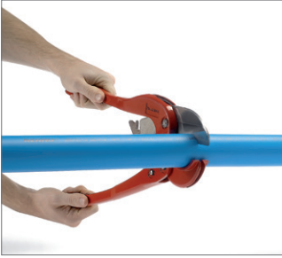
图 39 1. 将管无毛刺飞边且呈直角状剪出想要的长度
