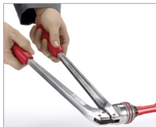
图 13 3. 将管道用扩张钳扩张两次，两次之间扩张钳需被旋转30°。作为选择，也可使用扩展器进行扩张（没有在图中被描绘出来）。基本上将扩张工具插到头，但是不允许歪曲。套环不允许处于扩张区域中。
