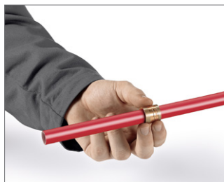
图 12 2. 将套环推至管上。套环内部的夹紧端必须要指向管的末端。
