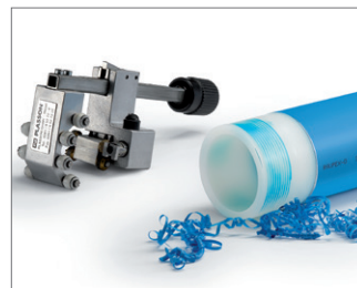
图 68 如果使用削皮机器，仅仅只需削一次。残留在管道上的包覆层不影响焊接过程，只要最上层（氧化层）被去除了。
