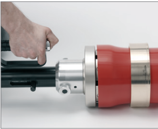
图 29 4. 将接头插入管中的时间 被在扩张头全开情况下（扩张过程的最后位置）的扩张压力所持续的时间影响。
