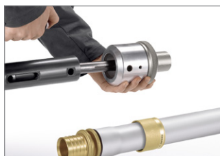
图 21 5. 将扩张单元从工具上卸下。
