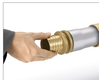
图 20 4. 将接头插入管中。短时间后，接头将被夹紧在管中。对于尺寸超过110的 RAUTHERM-FW 管道，需用瑞好润滑剂在连接区域进行均匀浸润。
