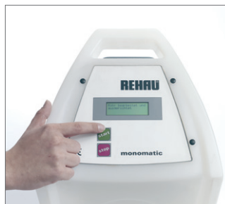
图 58 6. 按下焊接机器的开始按钮并且遵从指示说明。 比较屏幕上的焊接参值和钻孔夹上的参数。
