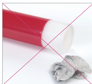
图 121 不要使用使用过的抹布来清洁管道。使用仅仅不受水侵蚀、没有使用过、没有染过色或者脱纱及吸水的纤维素纸浆布。
