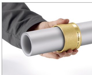
图 18 2. 将套环推至管上。套环内部的夹紧端必须要指向管的末端。
