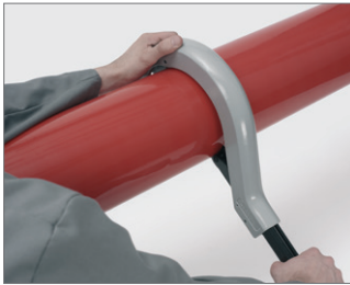
图 26 ……作为替代，也可以使用旋转式管道剪。
