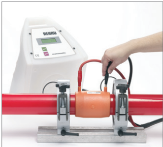
图 100 连接焊接机器；红色电缆接于红色触点上。焊接参数将被自动识别。
