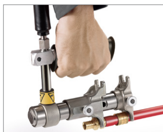
图 15 5. 将工具置于连接处。工具不允许歪斜。工具必须被完全并且以呈直角的形式被放置。
