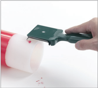
图 94 必须用手刮刀完全去除颜色残留。
