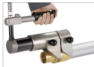
图 24 8. 将套环推至接头凸缘处。连接马上可以受压受热。
