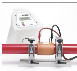
图 115 削过皮的管道需被迅速焊接。
