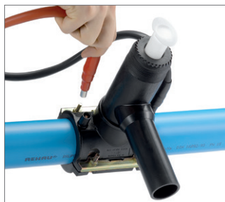
图 57 5. 连接焊接机器；红色线缆接于红色触点上。焊接参数将被自动识别。
