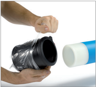
图 44 6. 电熔焊套筒在加工处理之前直接从袋子中取出。如有必要，电熔焊套筒也需使用 Tangit 清洁剂清洁。
