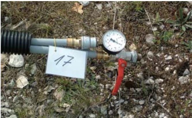
Fig. 60: Montaje de la unidad para pruebas de presión
