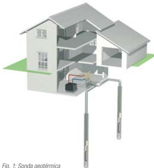
Fig. 1: Sonda geotérmica
