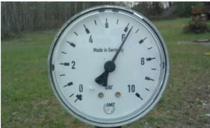
Fig. 61: Prueba de presión a 6 bar
