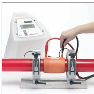
Fig. 18: Conectar la electrosoldadora REHAU: el cable rojo en el terminal rojo. Los parámetros de soldadura son identificados automáticamente.
