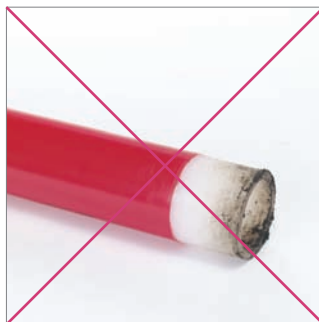
Fig. 36: La zona a soldar no debe estar ni mojada ni sucia.
