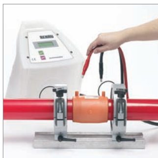
Fig. 22: Una vez completada la operación de soldadura suena una señal acústica. Se pueden desenchufar los conectores.
