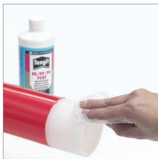
Fig. 13: La zona raspada debe estar libre de polvo y grasa. Limpiarla con una cantidad suficiente de limpiador Tangit y dejar que el producto se evapore completamente.
