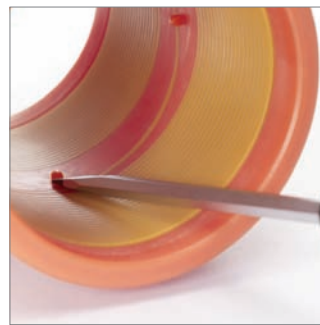
Fig. 30: En caso de utilizar el manguito como manguito de deslizamiento, se deberán eliminar los botones de tope.
