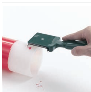
Fig. 12: Los restos de revestimiento se deben eliminar completamente con un rascador manual.
