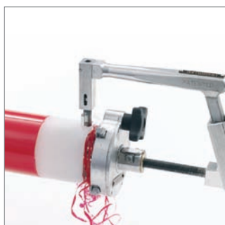
Fig. 11: Raspar el tubo RAUTHERM FW 2 veces.
