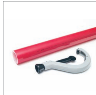
Fig. 08: Cortar a la medida deseada. El plano de corte debe ser recto, perpendicular al eje del tubo y estar libre de rebabas.
