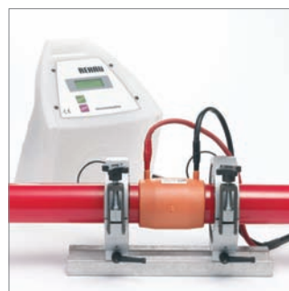
Fig. 20: Comprobar la alineación (= ausencia de tensiones) y la profundidad de inserción.
