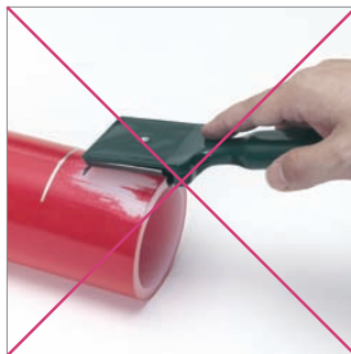
Fig. 40: No raspar los tubos con un rascador manual; utilizar éste exclusivamente para el repasado. Utilizar siempre rascadores rotativos (ver la lista de precios).
