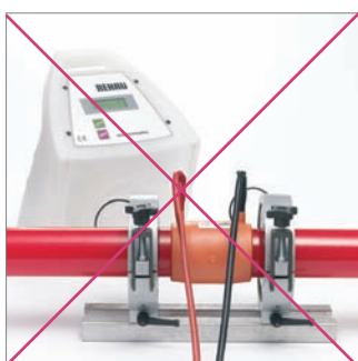
Fig. 43: Los cables de conexión de la electrosoldadora no deben transmitir fuerzas al manguito durante la soldadura.
