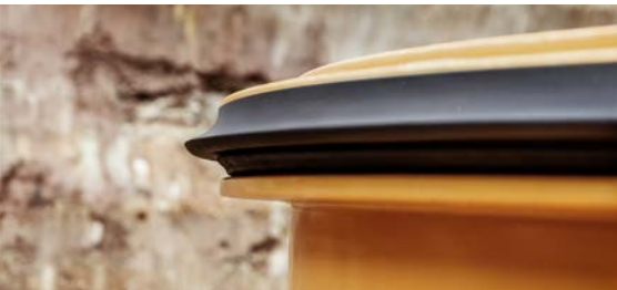
Abb. 05-28 Korrekten Sitz der Dichtung sicherstellen
