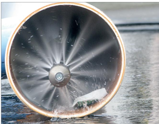
Abb. 6-2 Reinigung mit Wasserhochdruck
