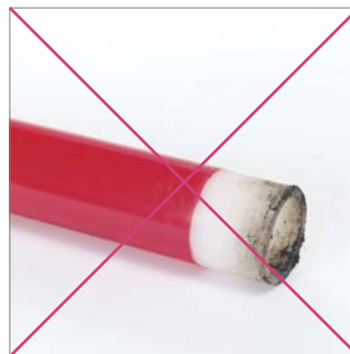
Abb. 36: Schweißzone darf weder nass noch verschmutzt sein.
