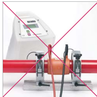
Abb. 43: Anschlusskabel des Schweißgerätes darf während der Verschweißung keine Kraft auf den Fitting einleiten.
