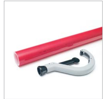
Abb. 08: Gewünschtes Maß ablängen. Schnittfläche muss gerade, rechtwinklig zur Rohrachse und gratfrei sein.
