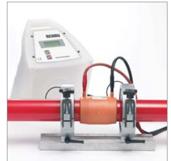
Abb. 20: Ausrichtung (= Spannungsfreiheit) und Einstecktiefe überprüfen.
