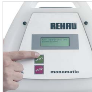
Abb. 19: Startknopf des Schweißgerätes drücken und Anweisung wie folgt überprüfen. Schweißparameter im Display mit Werten auf dem FUSAPEX-Elektroschweißfitting vergleichen.
