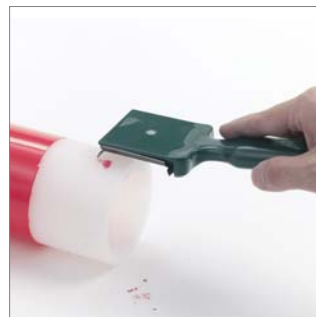
Abb. 12: Farbrückstände müssen mit einem Handschaber komplett entfernt werden.
