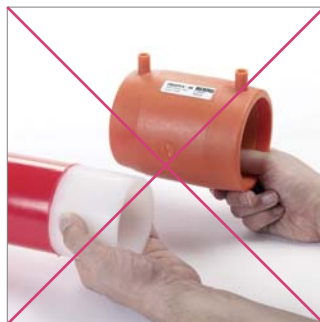
Abb. 35: Schweißzonen nicht berühren. Notfalls verunreinigte Schweißzonen immer mit Tangit vor dem Verschweißen reinigen.
