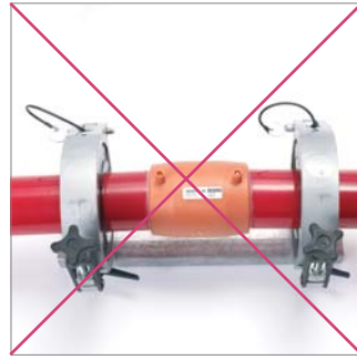
Abb. 39: Verbindung muss fluchten und darf nicht unter Spannung stehen, notfalls lösen und erneut fixieren.
