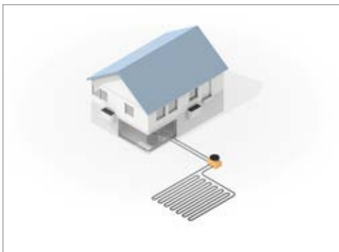
RAUGEO геотермальні колектори
