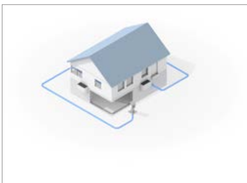
Ґрунтовий теплообмінник для систем вентиляції AWADUKT Thermo
