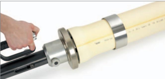
Rohr mit 1. Stufe zweimal um 30° versetzt aufweiten.
