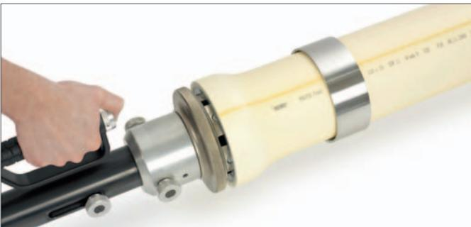
Rohr mit 2. Stufe (und 3. Stufe) zweimal um 30° versetzt aufweiten.
