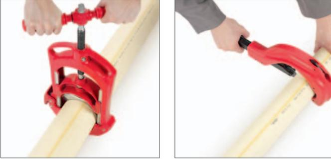
Rohr auf das gewünschte Maß rechtwinklig mittels Rollenrohrabschneider (bis 75 × 6,8) oder Guillotine ablängen.
