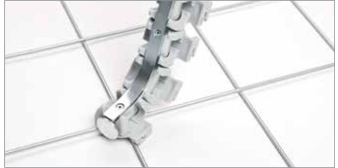
Fig. 11-19 Posizionamento dell'attrezzo per l'applicazione delle clip alla rete metallica
