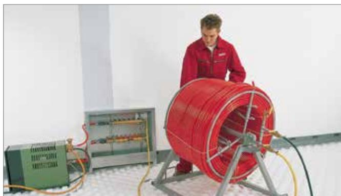
Fig. 12-9 Sbobinatore REHAU a caldo
