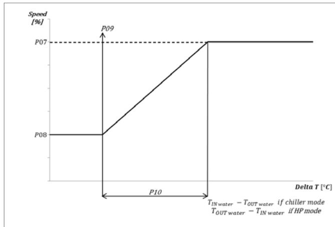
In produzione sanitaria la pompa viene forzata alla massima velocità.
