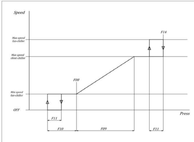
Nella modalità chiller è attivo un periodo di preventilazione: prima dell'accensione del compressore, il ventilatore viene acceso per 5 secondi; la velocità del ventilatore è proporzionale alla temperatura di condensazione, tuttavia, se il regolatore richiede il cut-off durante questo periodo, il ventilatore va alla velocità minima impostata. Questa funzione impedisce che il compressore parta con temperature di condensazione troppo elevate.
