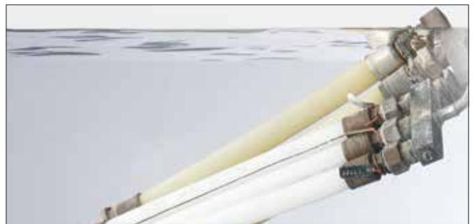
Fig. 3-4 Tubi sottoposti a prova di durata (sotto pressione in bacino d'acqua)
