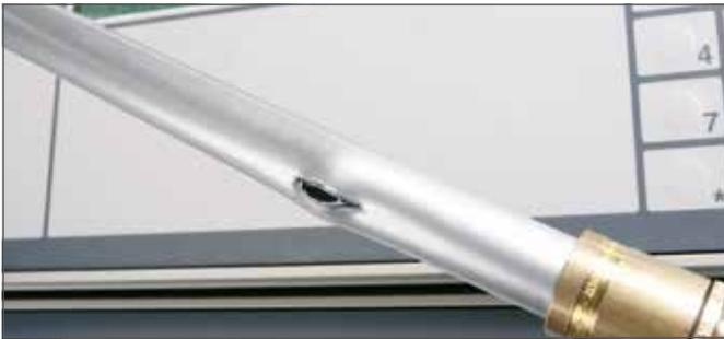
Fig. 3-1 Risultato di una prova della pressione di scoppio di un tubo
