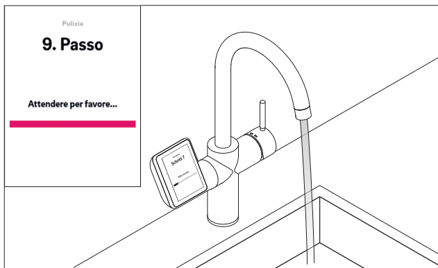
9. Dopo 10 min. di azione, il sistema esegue un risciacquo con 12,5 l di acqua fredda. Dopodiché, l'acqua non deve più apparire colorata. Se continua ad esserlo, prelevare acqua fredda al termine dell'intero processo di pulizia finché non esce trasparente.
