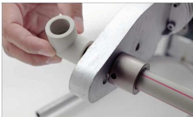
图 8-6 加热管道和管件
