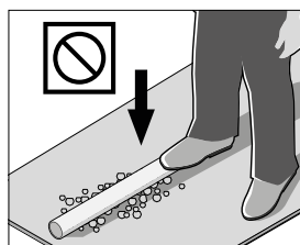
Abb. 03-8 Rohre vor mechanischer Beschädigung schützen
