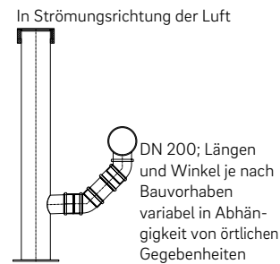
Abb. 05-20 Einfachabzweig, Darstellung in Strömungsrichtung der Luft
