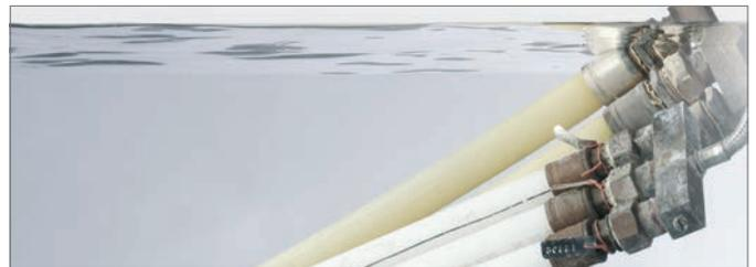
Abb. 3-4 Rohre im Langzeittest (unter Druck im Wasserbecken)
