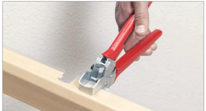
Abb. 17-34 Sockelleistenkanal-Oberteil ausklinken
