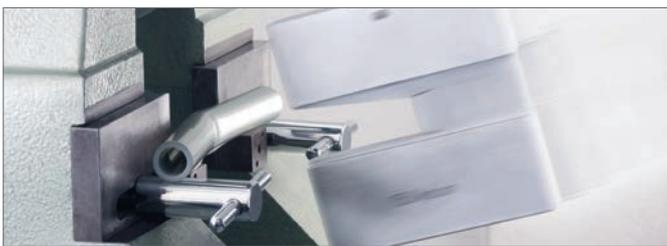
Abb. 3-2 Universalrohr RAUTITAN flex im Kerbschlag-Prüfgerät
