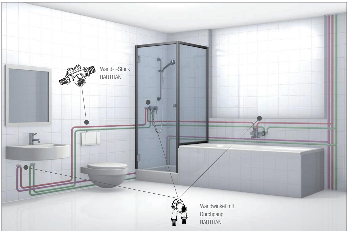
Abb. 5-8 Beispielschema Reihen- und Ringleitung
