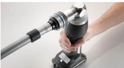
Schritt 1: Rohr einmal aufweiten
