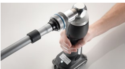
Schritt 1: Mit dem QC1 das Rohr 1x aufweiten
