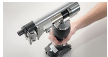
Schritt 3: Schiebehülse aufschieben
