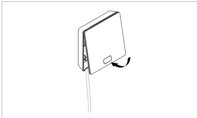
Fig. 8-3 Termostato ambiente NEA SMART 2.0 chiudere il coperchio
