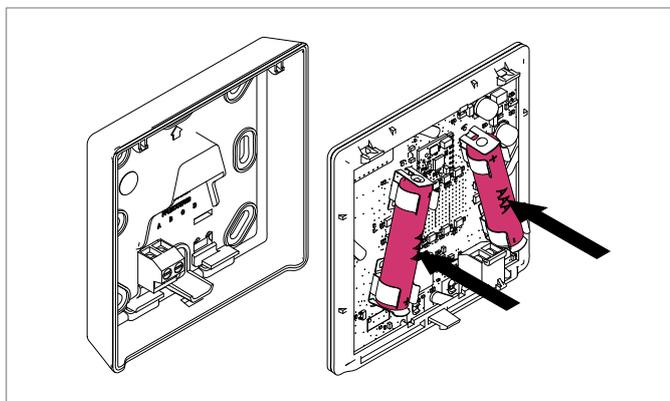
Fig. 8-2 Termostato ambiente NEA SMART 2.0 Sostituzione delle batterie
