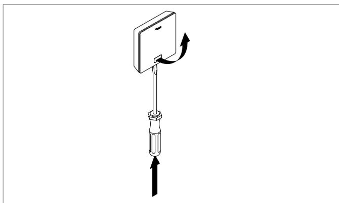
Fig. 8-1 Apertura del termostato ambiente NEA SMART 2.0
