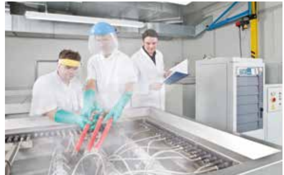
Fig. 06-20 Nel test a lungo termine, i tubi vengono esaminati per la loro temperatura e resistenza alla pressione
