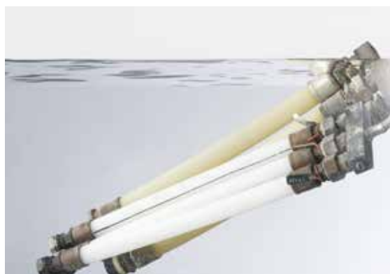
Fig. 03-9 Prova di resistenza alla pressione interna
