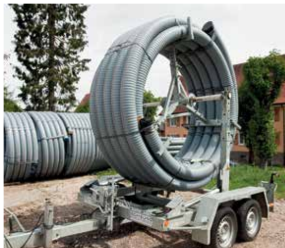
Fig. 07-34 Dispositivo di srotolamento verticale mobile
