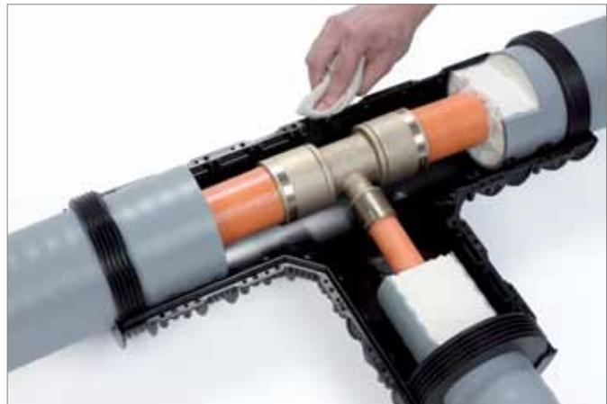
18. Bestreichen Sie die Klebeflächen der unteren Schale lückenlos mit dem beigelegten Schnellkleber. Kleber im Bereich der Dichtringe bis ganz an den inneren Rand aufbringen.
