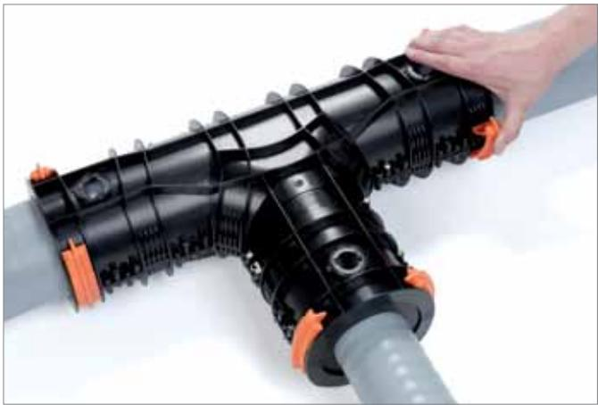
21. Montieren Sie die restlichen Spannklammern und beginnen Sie mit der langen Seite des T-Stückes (siehe Markierung A).
