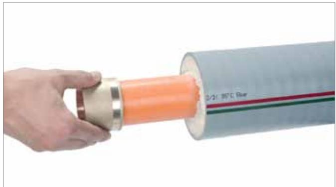
9. Weiten Sie das Rohr zweimal um ca. 30 ° versetzt auf. Bei DUO Röhren das zweite Rohr gleich aufweiten, bevor der Fitting eingesteckt wird.
