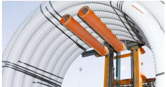
Fig. 41 Srotolamento con muletto
