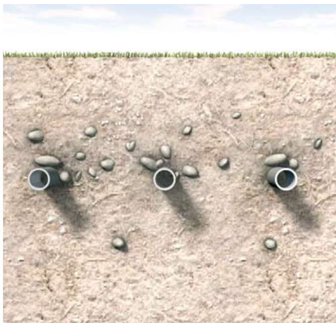
Fig.11: Sezione scavo per collettore RAUGEO collect PE-Xa e PE-Xa plus
