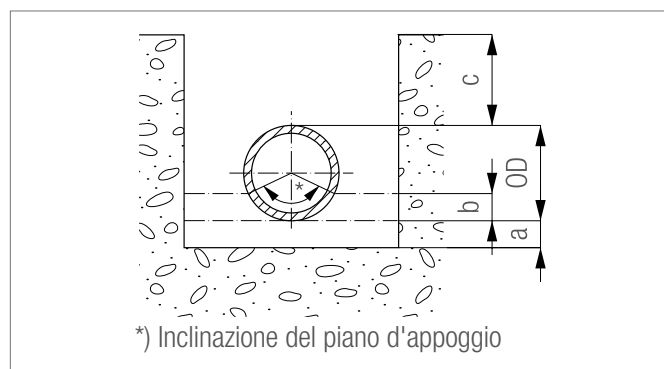
Fig. 5-10 Letto di posa 1 secondo la norma DIN EN 1610
