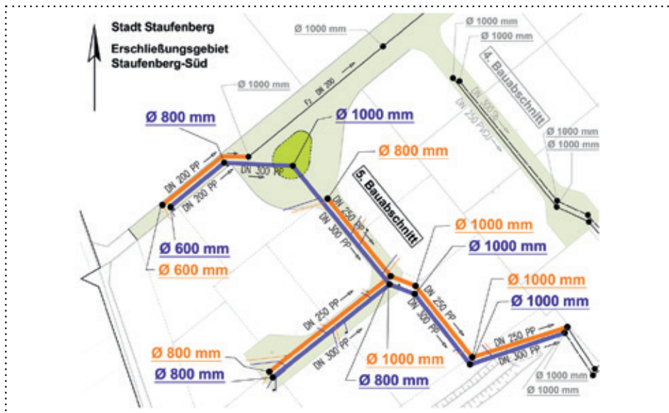
Abbildung 4: Bedarfsgerechte Schachtplanung: 2x DN 600, 4x DN 800 und 7x DN 1000 aus Kunststoff
