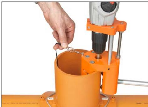
16. Die Öffnung beim Hauptrohr durch Drehen der Fräsvorrichtung im Uhrzeigersinn herausfräsen. Falls notwendig, den Anfahrpunkt durch mehrmalige links/rechts Drehung überfahren, um einen sauberen Schnitt zu erhalten. Die Späne im Fräsbereich entfernen.
