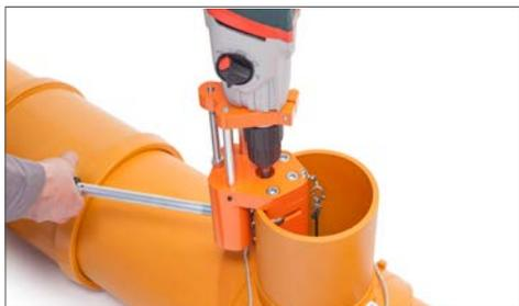
17. Führungsrollen mittels Knebelschraube zurückziehen. Fräsvorrichtung und ausgefräste Scheibe herausnehmen und Spannseil entfernen.
