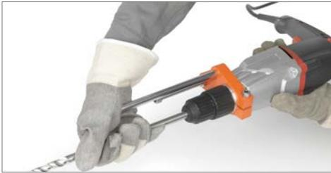
13. Bauteil 1 inkl. Bohrmaschine in Bauteil 2 bis zur Verstelle schraube (Abstand ca. 9 cm) einführen und mit Madenschraube M6 beidseitig sichern.
