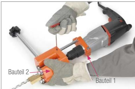
14. Die Führungsrollen mittels Knebelschraube gegen den Uhrzeigesinn zurückziehen. Fräsvorrichtung in den Sattelabgang senkrecht einführen und dabei das Hauptrohr anbohren. Die Knebelschraube bei laufender Bohrmaschine anziehen, bis die Führungsrollen spielfrei am Sattelabgang anliegen.
