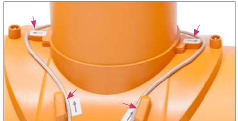
8. Spannmutter anbringen und mit Steckschlüssel SW13 **ohne** zusätzlicher Hebelverlängerung handfest anziehen. Lage des Spannseiles nochmals überprüfen.
