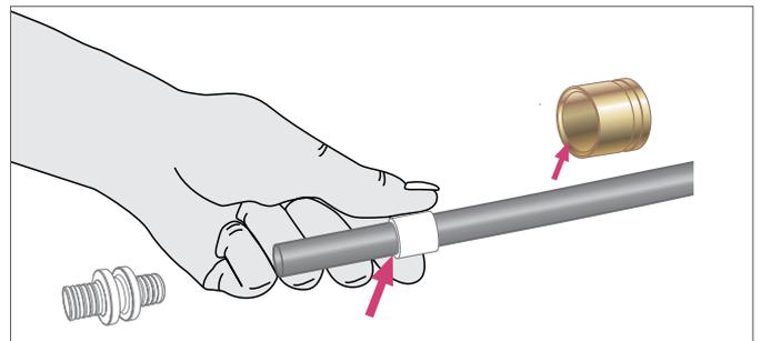
Schiebehülse so weit auf das Rohr schieben, dass zwischen Rohrende und Schiebehülse mindestens die zweifache Schiebehülsenlänge frei ist.
