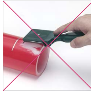
Abb. 40: Rohre nicht mit Handschaber schälen, diesen nur zur Nacharbeit verwenden. Immer Rotationsschäler verwenden. Immer Rotationsschäler einsetzen (siehe Preisliste).
