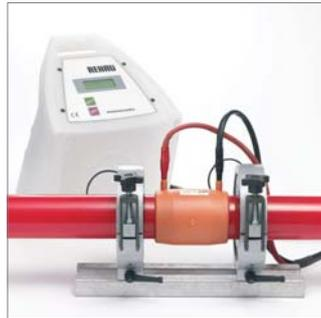
Abb. 32: Geschälte Rohrenden sind zeitnah zu verschweißen.
