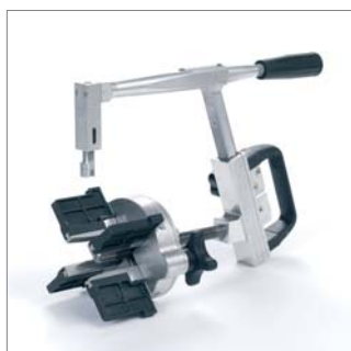
Abb. 10: Zum Schälen der Rohrenden ist ein Rotationsschäler zu verwenden (Empfehlung siehe Preisliste).
