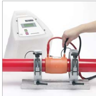
Abb. 18 REHAU Schweißgerät anschließen, rotes Kabel auf roten Kontakt. Schweißparameter werden automatisch erkannt.
