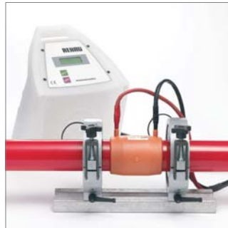
Abb. 32: Geschälte Rohrenden sind zeitnah zu verschweißen.
