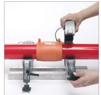
Abb. 24: Nach der am Fitting angegebenen Abkühlzeit „cool ... min“ darf die Universalrohrhalteklemme demontiert werden.
