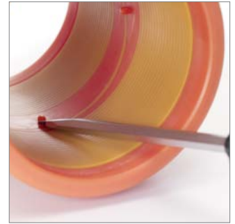
Abb. 30: Falls Muffe als Überschiebmuffe eingesetzt werden soll, sind die Anschlagrippel zu entfernen.
