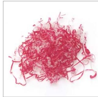
Abb. 44: Beim Abschälen sollte ein langer und gleichmäßig dicker (0,1 bis 0,2 mm) Span entstehen, evtl. Rotationsschäler prüfen und/oder Messer wechseln.
