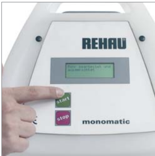
Abb. 21: Nochmaliges drücken des Startknopfes löst den Schweißvorgang aus.
