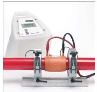
Abb. 20: Ausrichtung (= Spannungsfreiheit) und Einstecktiefe überprüfen.
