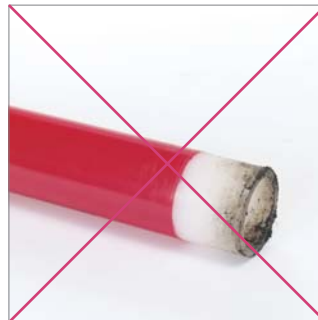
Abb. 36: Schweißzone darf weder nass noch verschmutzt sein.
