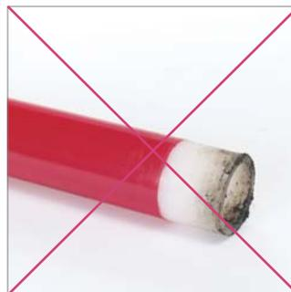
Abb. 36: Schweißzone darf weder nass noch verschmutzt sein.
