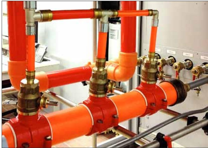
*Bild 2. Temperatur-Lastwechselprüfung*
