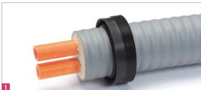
1 Mettez les joints d'étanchéité en place (attention au positionnement des lèvres du joint). Si nécessaire, nettoyez les joints d'étanchéité et le tube. Reliez les tubes de service (voir 5.3).
