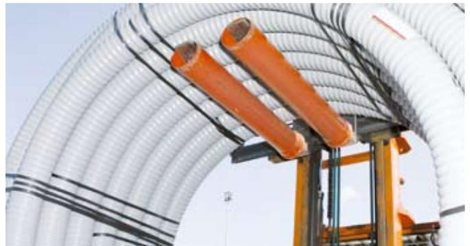
Fig. 5.4 - Préhension avec chariot élévateur
