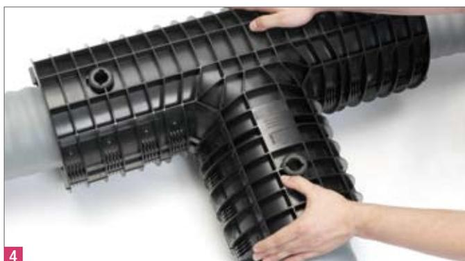
4 Mettez en place la demi-coquille supérieure (celle qui comporte un trou) et appuyez sur celle-ci. Vérifiez le positionnement des joints d'étanchéité sur toute la circonférence, une fois la demi-coquille supérieure mise en place.
