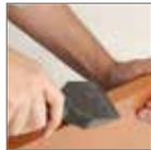
4.- Presionar el canto para lograr mayor adherencia. Puede utilizarse, en este punto, una espátula de madera o PVC para no dañar la superficie del canto.
