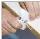
8.- Para lograr una terminación óptima con radios perfectos, es necesario utilizar el refilador manual CUTTER SET de REHAU o un tupí.
