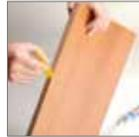
1.- Aplicar una capa de adhesivo de contacto en forma pareja una capa de adhesivo de contacto en la cara interior del canto que se aplicará. Dejar secar.
