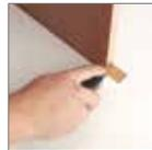
5.- Utilizar una trincheta o sierra para realizar el retestado.
