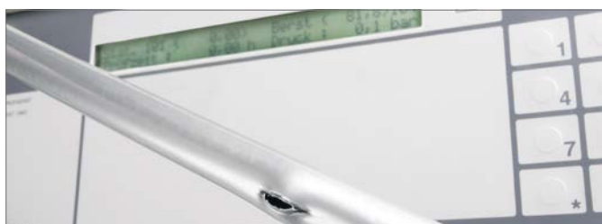
Obr. 3-1 Výsledok tlakovej skúšky podľa Bersta s univerzálnou rúrkou RAUTITAN flex
