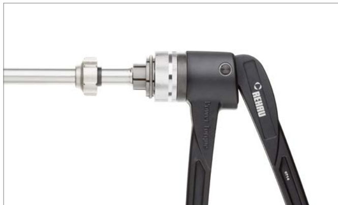
Obr. 14-3 Rozšírenie konca rúrky na jeden raz
