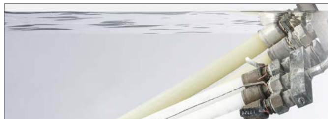
Obr. 3-4 Rúrky v dlhodobej skúške (pod tlakom vo vodnej nádrži)
