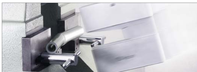
Obr. 3-2 Univerzálna rúrka RAUTITAN flex v prístroji na aplikáciu rázovej vrubovej skúšky
