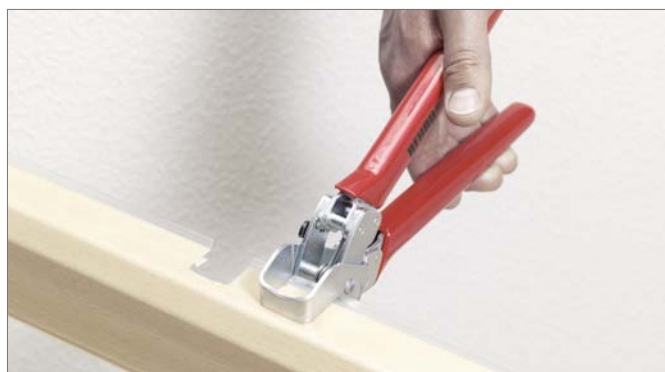
16-39. ábra A falszegély csatorna felső részének kivágása
