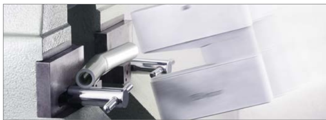
3-2. ábra Univerzális RAUTITAN flex cső ütővizsgálata készülékben
