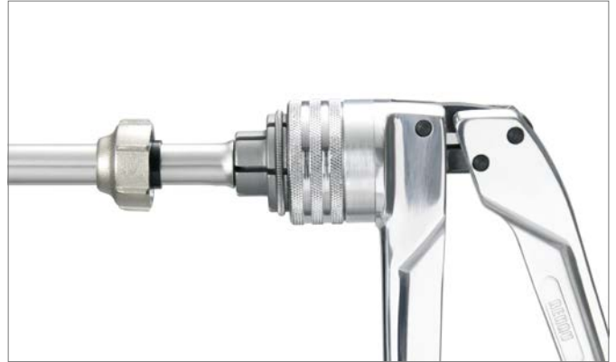
13-2. ábra A csővég egyszeri feltágítása
