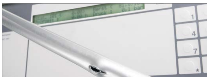
3-1. ábra Repeszőnyomás vizsgálat eredménye az univerzális RAUTITAN flex csőnél
