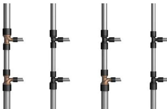
Fig. 05-6 Exemples de raccordement d'une conduite circulaire
