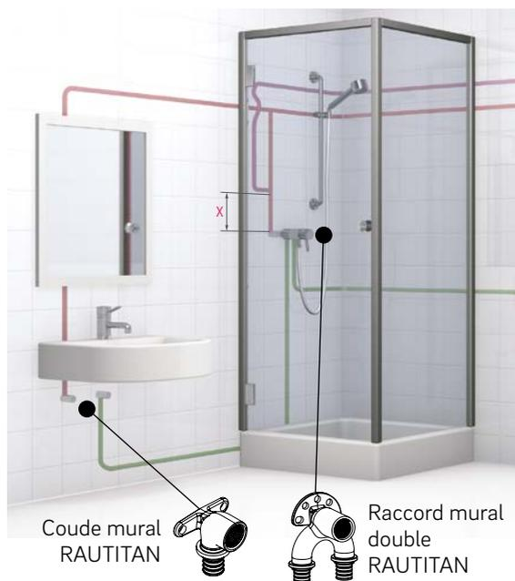
X distance recommandée du raccordement à l'eau chaude, voir tableau ci-dessous
