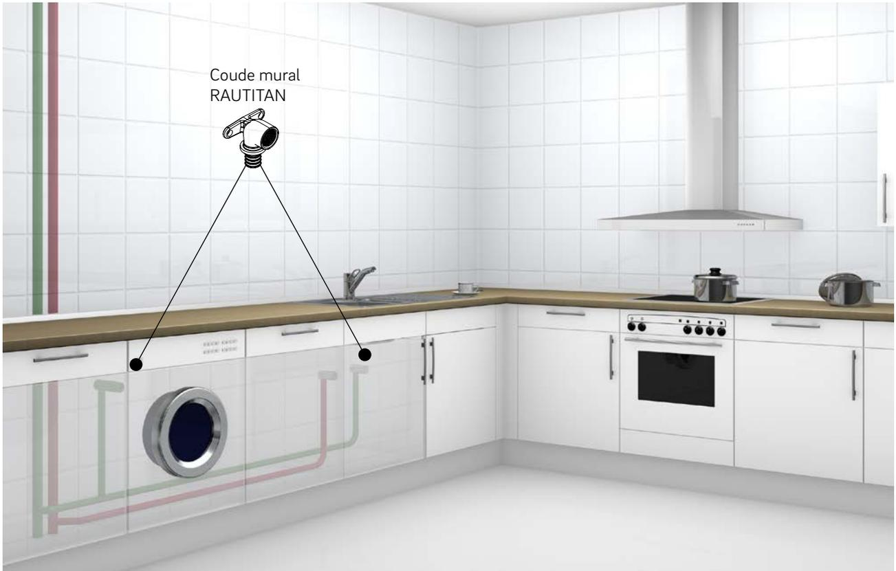
Fig. 05-2 Pose en T de la conduite d'étage/individuelle avec un volume d'eau < 3 l - Exemple de la cuisine
