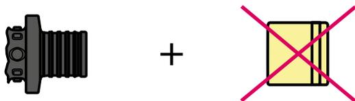
Fig. 38-1 Combinaison RAUTITAN PX avec douille coulissante en laiton non autorisée
