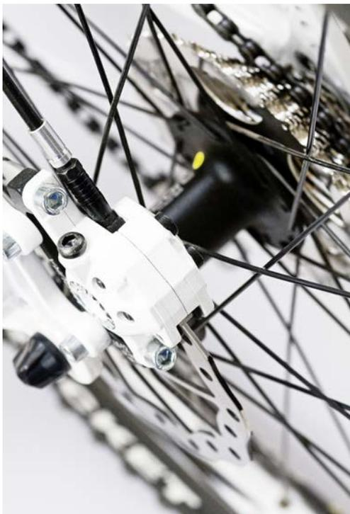
Das Anforderungsprofil an die kleindimensionierten Hochdruckschläuche ist hoch, nicht zuletzt bedingt durch den enormen Betriebsdruck von ca. 100 bar, der vergleichbar mit dem Arbeitsdruck eines Hochdruckreinigers ist. Der Berstdruck liegt bei > 1.000 bar, in einigen Sonderanwendungen sogar bei bis zu 1.600 bar, denn im Bereich der Scheibe wird es beim Bremsen richtig heiß.
