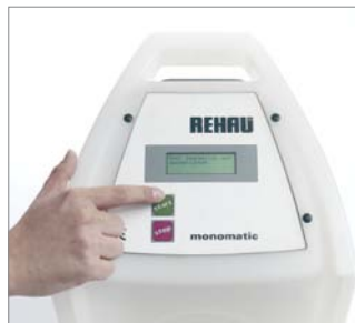
101. ábra A hegesztőkészülék indítógombjának megnyomása. A kijelzőn megjelenő hegesztési paraméterek összehasonlítása a FUSAPEX elektrokarmantyún szereplő értékekkel.
