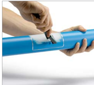
54. ábra 2. A két jelölés közötti részen a haszoncső palástjának feléről a fedőréteget el kell távolítani. A forgács vastagsága kb. 0,2 mm legyen.
