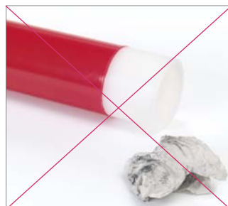
121. ábra A tisztítást tilos már előzőleg használt törőruhával végezni. Csak vízálló, új, színezetlen, szőszmentes és jó nedvszívó képességű cellulózkendőt szabad használni.
