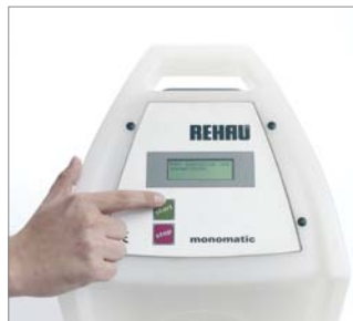
58. ábra 6. A hegesztőkészülék indítógombjának megnyomása és az utasítások követése. A kijelzőn megjelenő hegesztési paraméterek összehasonlítása a megfúró bilincsen szereplő értékekkel.
