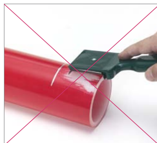
124. ábra A csövek hántolását ne kézi hántolóval végezze, azok csak utómegmunkálásra szolgálnak! Mindig csőhántolót használjon (lásd az árlístát!)
