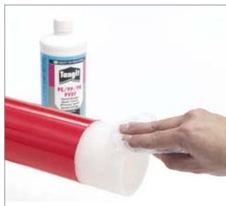
95. ábra A hegesztési zónának zsír- és pormentesnek kell lennie. Szükség esetén Tangit oldattal tisztítsa meg a felületet, majd szert hagyja teljesen elpárologni!
