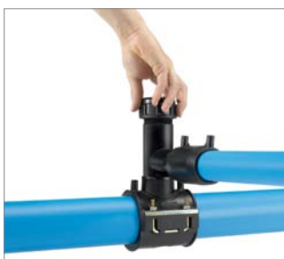
64. ábra 12. A sapkát addig csavarja, amíg a kicsavarodásgátló felütközik.
