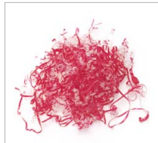
112. ábra Hántoláskor hosszú, egyenletesen vastag forgácsnak kell keletkeznie (0,1–0,2 mm); szükség esetén használjon forgó hántolót és/vagy kést!
