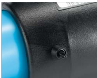
78.  bra A hegeszt tt k t s elk sz lt  ut n a karmant y m nk t v g n el b j k egy-egy jel z csap.
