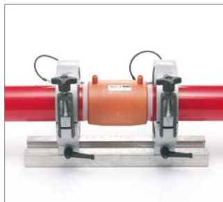
99. ábra Készítse elő a másik csővéget, tolja be teljesen az elektrokarmantyúba, majd rögzítse a csőtartó bilincsekkel.
