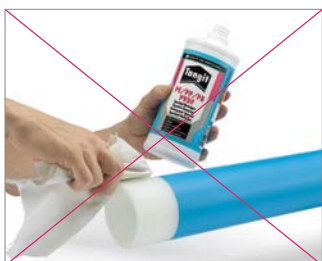
74.  bra A tiszt t s t tilos m r el z leg haszn lt t rl ruh val v gezni! Csak v z ll ,  j, sz nezetlen, sz szmentes  s j  sz v k pess g  cellul zkend t szabad haszn lni.
