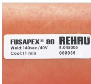
105. ábra Az idomon feltüntetett „cool...min” lehűlési idő alatt tilos a kötést mechanikus terhelésnek kitenni.
