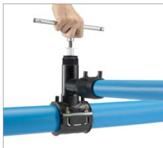
61. ábra 9. Nyomáspróba után 12-es imbuszkulccsal csavarja be a lyukasztót!
