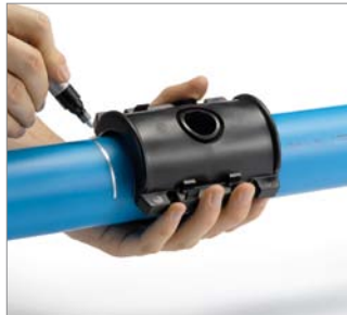
53. ábra 1. A megfúró bilincs alsó részének odailllesztése és megjelölése a kívánt helyen.
