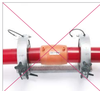
123. ábra A kötésnek egyenesnek kell lennie és nem állhat feszültség alatt. Szükség esetén lazítsa meg a megfogást és rögzítse újra!
