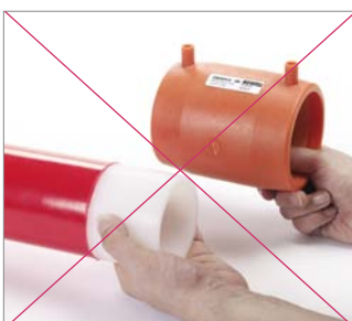
119. ábra Ne érintse meg a hegesztési zónákat. A szennyeződött hegesztési zónát szükség esetén tisztítsa meg Tangit oldattal a hegesztés előtt!
