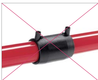
70.  bra Az EVOH r teggel (= oxig ndiff zi -z r  r teg) bevont cs vekhez tilos elektrokarmant yt haszn lni!
