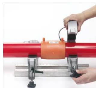
106. ábra Az idomon feltüntetett „cool...min” lehűlési idő letelte után az univerzális csőtartó bilincs leszerelhető.
