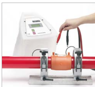
104. ábra A hegesztési folyamat befejezése után egy hangjelzés hallható. A kijelzőn megjelenik az „OK” kijelzés, ez után a csatlakozók eltávolíthatók.
