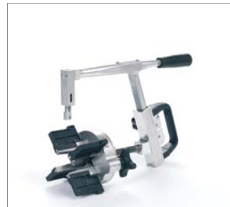
92. ábra A csővégek hántolásához használjon forgó hántolót!
