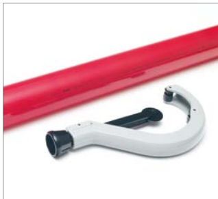
89. ábra Vágja le a csövet a kívánt méretre! A vágásfelület legyen egyenes, a csőtengelyre merőleges és sorjamentes.
