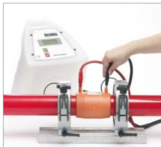
100. ábra A REHAU hegesztőkészülék csatlakoztatása; a piros kábel ráhelyezése a piros érintkezőre. A készülék automatikusan felismeri a hegesztési paramétereket.
