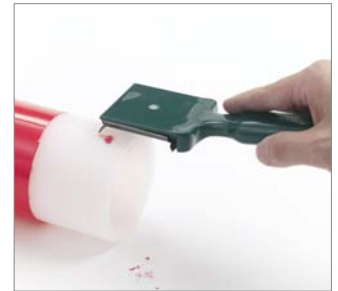
94. ábra A festékmарadványokat kézi hántolóval teljesen távolítsa el!
