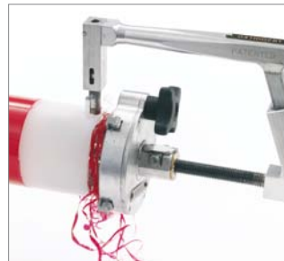
93. ábra A csővek hántolását kétszer végezze el!
