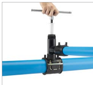
62. ábra 10. A csővezeték áttörése után a lyukasztót az óramutató járásával ellentétes irányban, ütközésig csavarja vissza!
