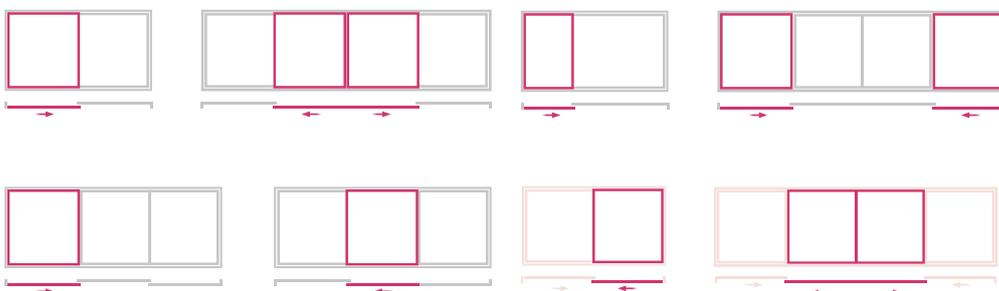
O sistema CE SYNEGO permite um sem número de possibilidades. Com uma **largura máxima de vão de 10 metros e uma altura até 2,6 metros**, tem à sua disposição infinitas opções de desenho. Também com as portas de correr eleváveis SYNEGO poderá realizar **larguras de passagem até 5 metros**. Máxima amplitude de passagem sem barreiras para o exterior.
