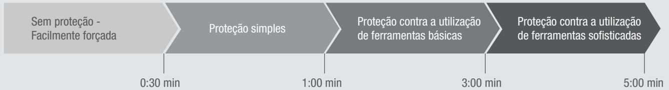
Ao prescindir de reforços adicionais de aço, graças ao estável **material composto com fibra RAU-FIPRO**, o sistema GENEÓ alcança a classe de resistência RC 2 mantendo intactos os valores de isolamento térmico. Caso seja necessário podem-se integrar reforços adicionais.
