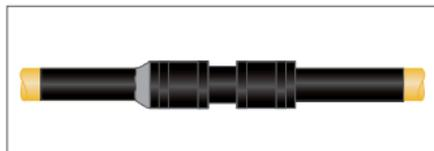
Fig. 6-7 Applicazione di stucco per colmare il "gradino" tra tubo e manicotto
