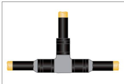
Fig. 6-9 Collegamento senza incavi (raccordo a T)
