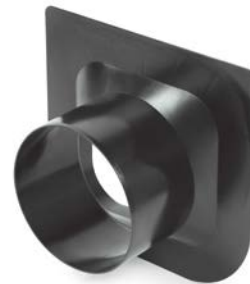
Frontanschlussstutzen zum Einstecken in die RAUSIKKO Box für den direkten sohlgleichen Anschluss DN 200 und DN 250
