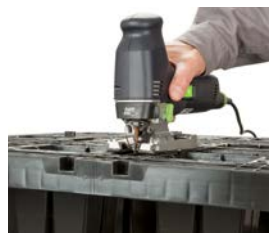
Zerteilen des Grundelementes entlang der Schnittmarkierung
