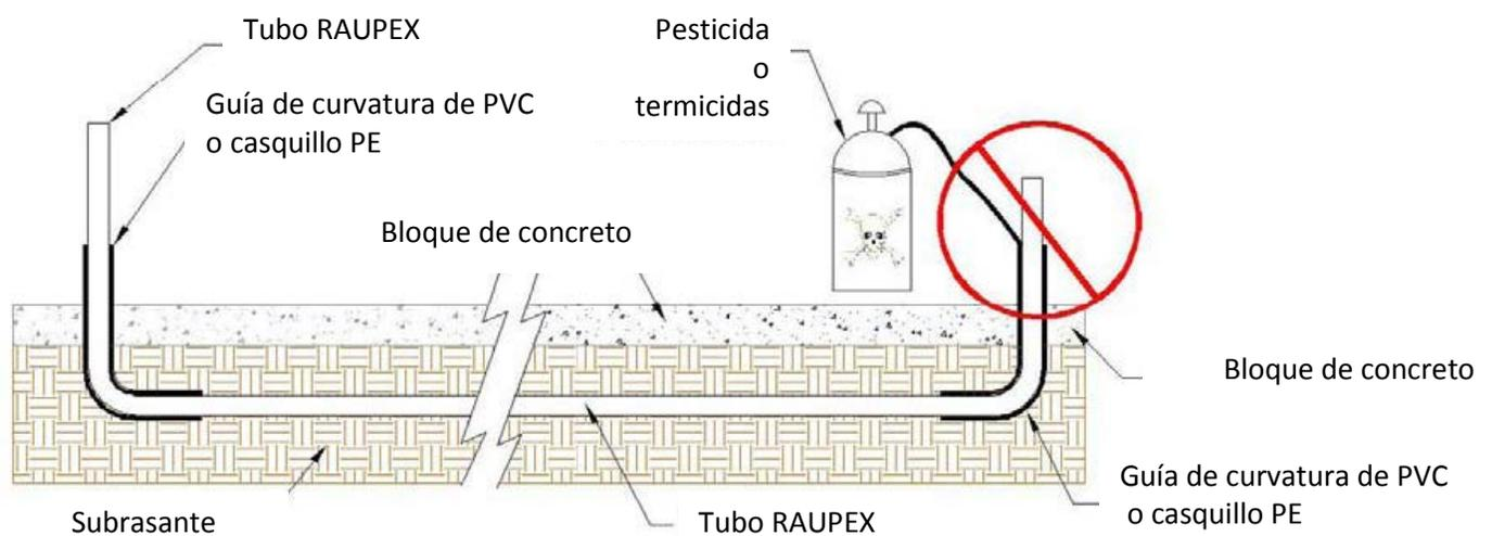
Figura 2: Instalación recomendada de tubos RAUPEX debajo de un bloque.
