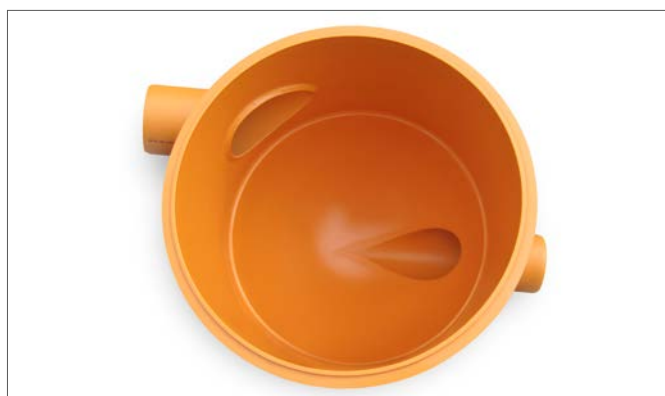
Die Fließgeschwindigkeit wird mit tangentialen Zulauf und Kugelboden stark verringert.
