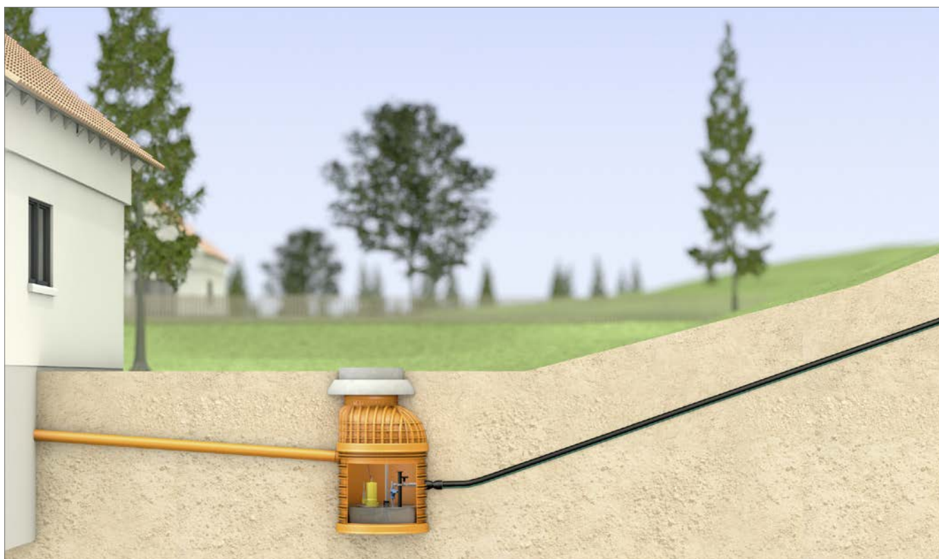
Pumpenschacht bei Höhenunterschieden zwischen Zubringerkanal und Hauptkanal.
