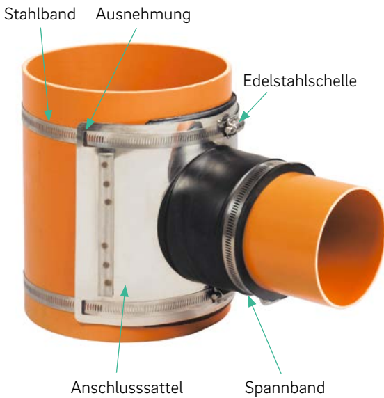
AWADOCK T-FLEX, das Anschlusssystem für glattwandige Haupt- und Anschlussrohre
