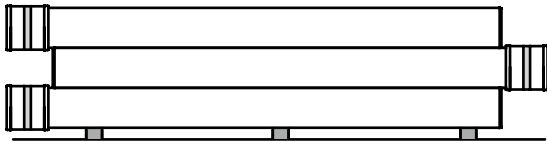
Lagerung mit Zwischenhölzern oder mit versetzten Muffen
