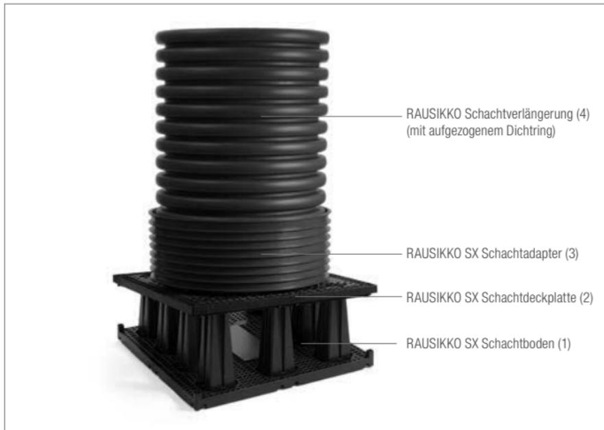
*RAUSIKKO Schacht für eine 0,5-lagige Versickerungs- / Retentionsanlage ( $H = 0,36\text{ m}$ )*
