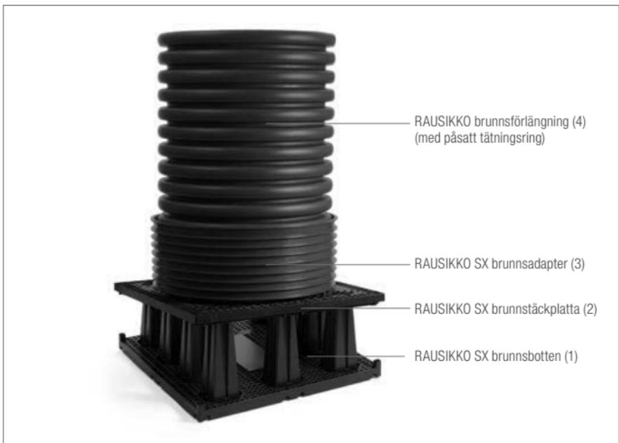
*RAUSIKKO brunn för infiltrations- / sedimenteringsanläggning i halva lager ( $H = 0,36\text{ m}$ )*
