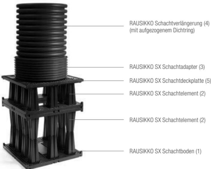
RAUSIKKO Schacht SX für eine 1,5 lagige Versickerungs- / Retentionsanlage ( $H = 1,02\text{ m}$ )
