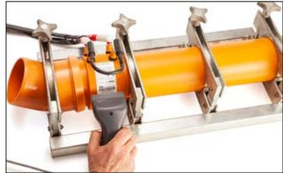
Nach vollständiger Durchführung der Vorbereitungs-schritte gemäß dieser Montageanleitung kann der Schweißvorgang begonnen werden. Zunächst sind die notwendigen Schweißparameter des Schweißadapters mittels Barcodescanner an das Schweißgerät zu übertragen.
