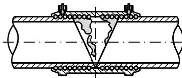
Bei eventuellem konischen Einfall des Rohrendes ist sicherzustellen, dass das unbearbeitete Rohr innerhalb der vorgesehenen Einstecktiefe mindestens im Bereich der Heizwendel den Nenndurchmesser aufweist. Rohrenden, die diese Bedingungen nicht erfüllen, müssen entsprechend gekürzt werden.
