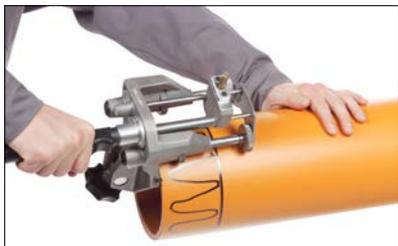
Um die lückenlose Bearbeitung der Oberfläche im Schweißbereich zu kontrollieren, empfehlen wir zusätzliche Markierungs-Kontrollstriche anzubringen. Diese müssen nach dem Schälvorgang komplett entfernt sein. Beschädigungen der Schweißoberfläche, wie z. B. Kratzer oder axiale Riefen, dürfen im Schweißbereich nicht vorhanden sein.
