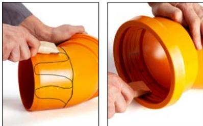
Bearbeitete Oberflächen im Schweißbereich sind vor ungünstigen Witterungseinflüssen (z. B. Feuchtigkeit, Reifbildung und sonstigen schädigenden Einflüssen (z. B. Fett, Schmutz)) zu schützen.
