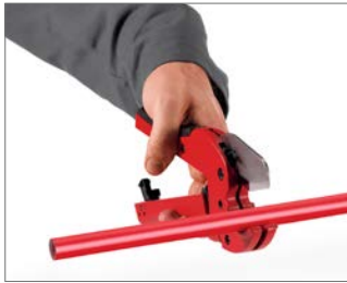
Abb. 11 1. Rohr mit Rohrschere gratfrei und rechtwinklig auf das gewünschte Maß ablängen.
