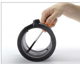
Abb. 77 Falls Muffe als Überschiebmuffe eingesetzt werden soll, sind die Anschlagrippel zu entfernen.
