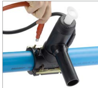
Abb. 57 5. Schweißgerät anschließen; rotes Kabel auf roten Kontakt. Schweißparameter werden automatisch erkannt.
