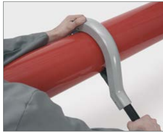
Abb. 26 ... alternativ kann auch der Rollenrohrabschneider eingesetzt werden.
