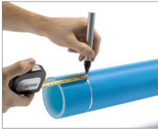
Abb. 65 Zum Anzeichnen PE-Stift in Kontrastfarbe verwenden.
