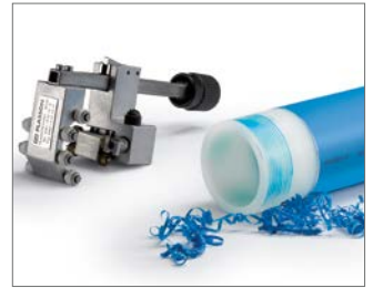
Abb. 68 Wenn Abschälgerät eingesetzt wird, nur einmal schälen. Reste der Ummantlung auf dem Rohr stören den Schweißablauf nicht, sofern die oberste Schicht (Oxidschicht) entfernt wurde.
