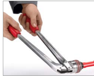
Abb. 13 3. Rohr zweimal um 30° versetzt mit Aufweitzange ausweiten. Alternativ dazu ist auch das Aufweiten mit Expanderbit möglich. (Nicht in der Abbildung dargestellt). Aufweitwerkzeug grundsätzlich bis zum Anschlag einstecken und nicht verkanten. Schiebehülse darf sich nicht in der Aufweitzone befinden.
