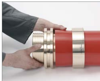
Abb. 30 5. Fitting in das Rohr einstecken. Nach kurzer Zeit sitzt der Fitting im Rohr fest (memory effect).
