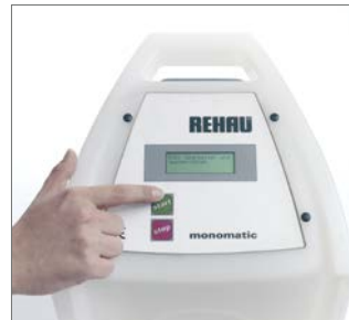
Abb. 48 10. Startknopf des Schweißgerätes drücken und Anweisung wie folgt überprüfen. Schweißparameter im Display mit Werten auf dem Elektroschweißfitting vergleichen.
