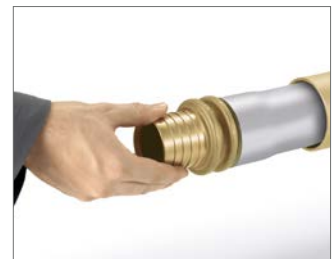
Abb. 20 4. Fitting in das Rohr stecken. Nach kurzer Zeit steckt der Fitting im Rohr fest. Bei RAUTHERM-FW-Rohren ab Dimension 110 ist das Rohr im Verbindungsbereich gleichmäßig mit Gleitmittel von REHAU zu benetzen.
