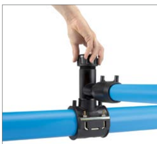
Abb. 64 12. Kappe aufdrehen bis Rückdrehsicherung anschlägt.
