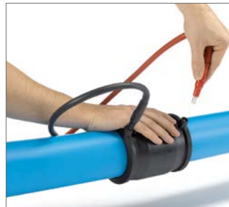
Abb. 47 9. Schweißgerät anschließen; rotes Kabel auf roten Kontakt. Schweißparameter werden automatisch erkannt.
