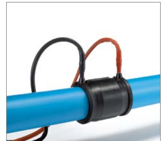
Abb. 49 11. Ausrichtung und Einstecktiefe überprüfen. Schweißung muss spannungsfrei erfolgen. Ggf. sind Rundrückklemmen oder Rohrhalteklemmen einzusetzen.
