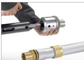
Abb. 21 5. Die Aufweiteinheit vom Werkzeug demontieren.
