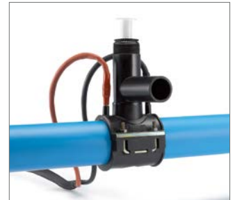
Abb. 59 7. Ein akustisches Signal ertönt nach Abschluss des Schweißvorganges. Die Stecker können entfernt werden.
