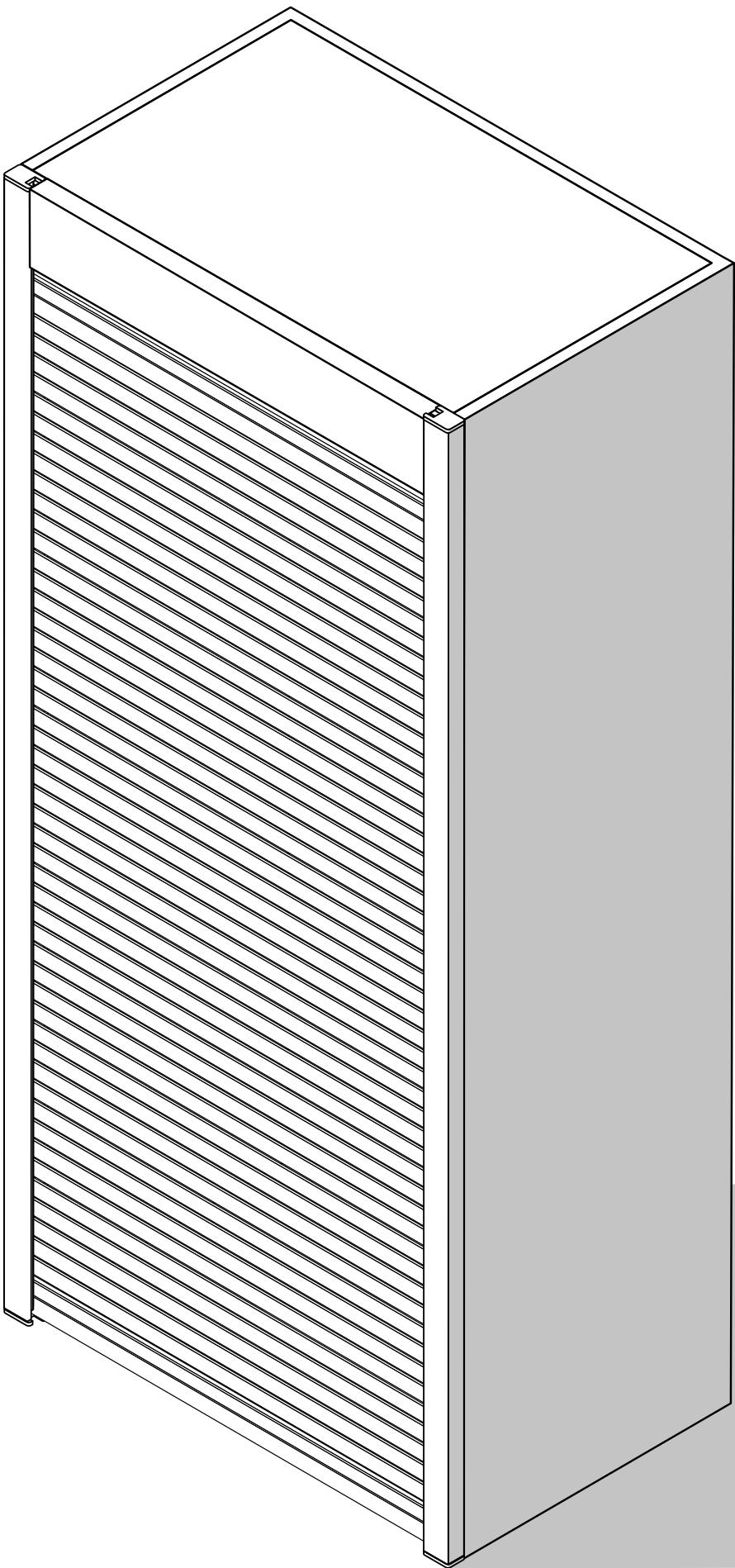
Sicherheitshinweis! Gemäß DIN EN 14749 muss die Jalousie nach der Endmontage so eingestellt sein, dass diese sich bei geöffnetem Zustand ab 200mm von der Schrankunterkante aus gemessen, nicht selbsttätig bewegt! Der Schrankhersteller ist verpflichtet, den genannten Hinweis an Weiterverarbeiter, Monteur und Endkunden weiterzugeben.
