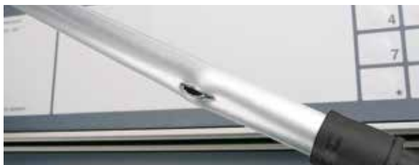
Рис. 1 Результаты испытания прочности на разрыв давлением. Испытуемый продукт – универсальная труба RAUTITAN flex
